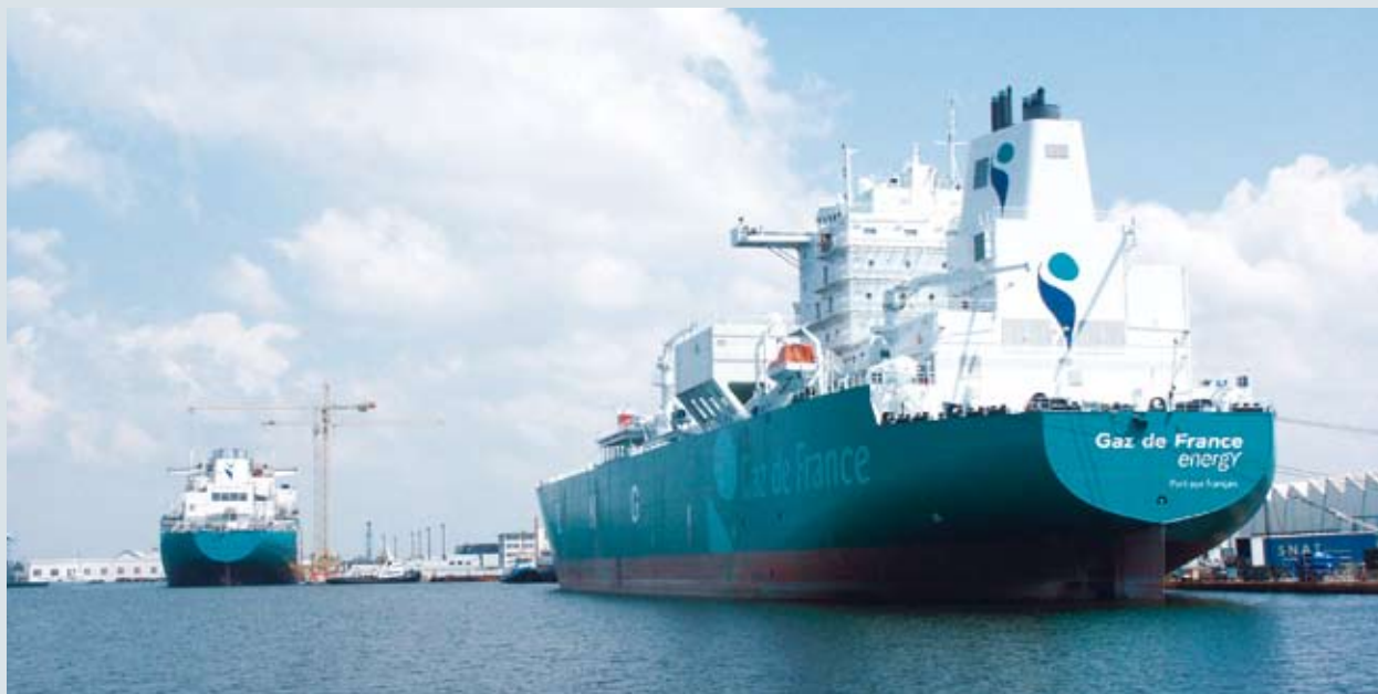
Bild 1: Verflüssigtes Erdgas LNG (liquified natural gas) wird heute zunehmend bei -163\text{ °C} drucklos mit speziellen Tankschiffen transportiert.
